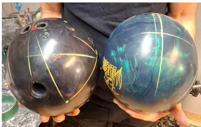
Förberedande linjering innan borring sker Observera dom två punkterna på vänstra klotet.
